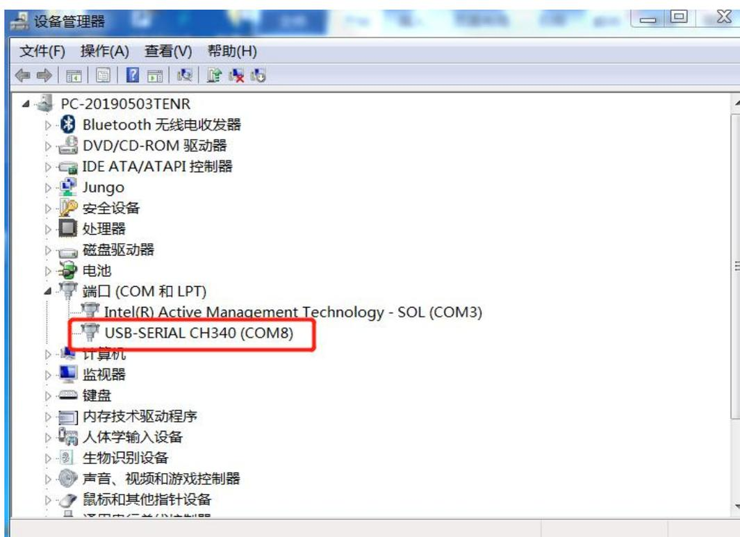
**注：如果之前未使用过 CH340 串口工具，系统需要安装驱动，可以用驱动精灵自动安装，我们提供的 USB 转 TTL 工具支持 WIN7 和 WIN10 系统；**
