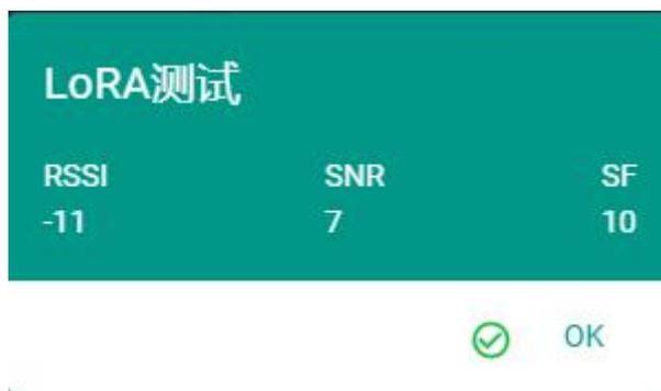
下图表示网关接收到距离传感器发送的数据，数据包内容“LoraTest”。
