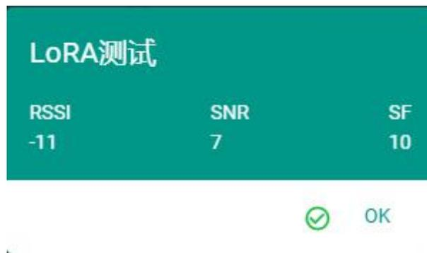
下图表示网关接收到环境光传感器发送的数据，数据包内容“LoraTest”。
