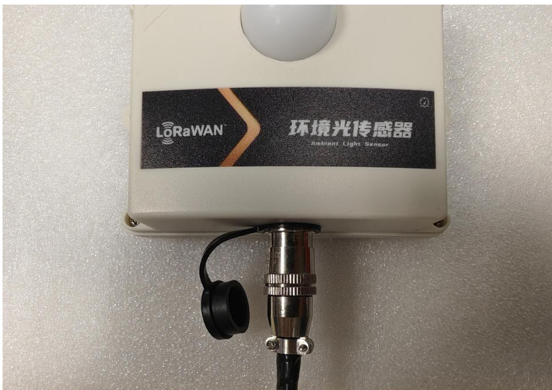
(4) 使用 USB 转串口设备将环境光传感器与电脑连接。
