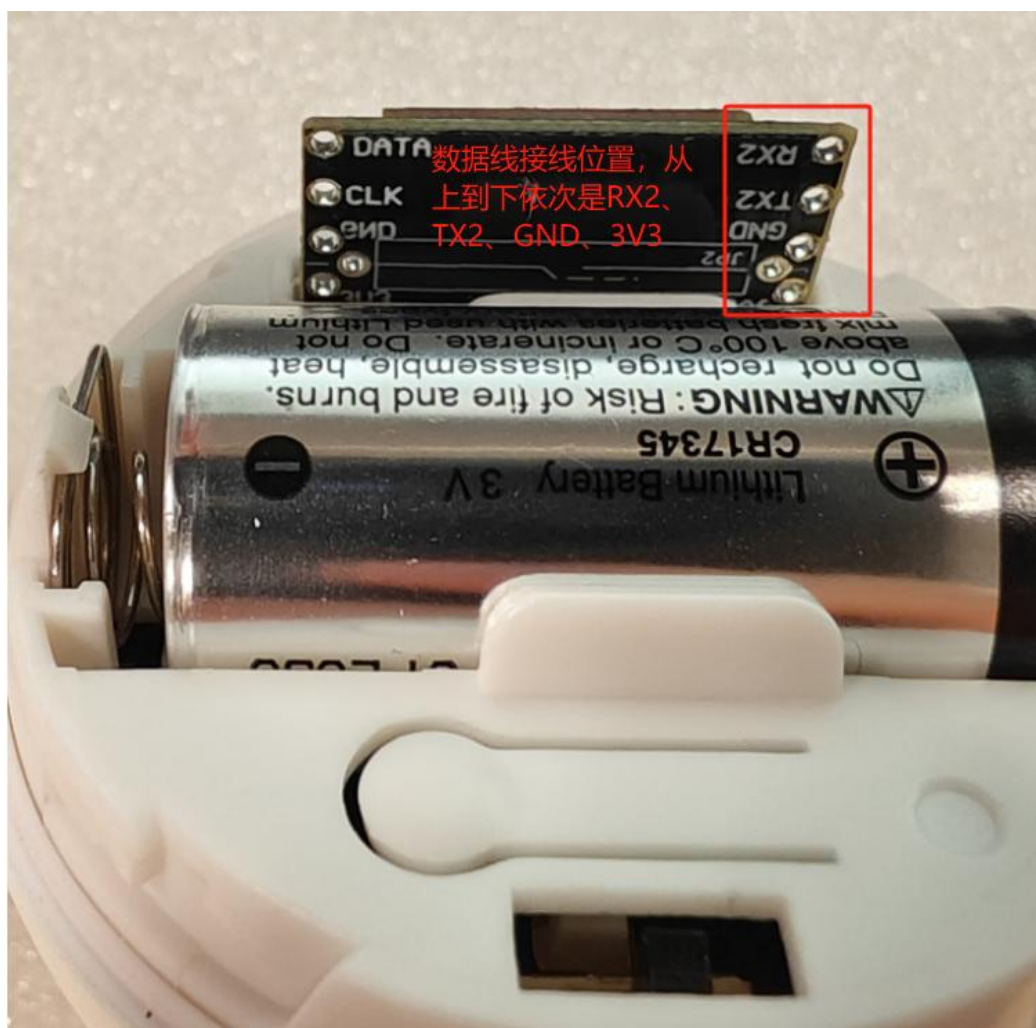
(3) 配置数据线与传感器串口对应接上。
